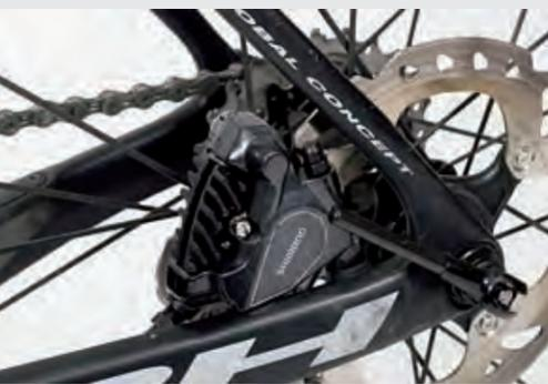
Los anclajes tipo Flat Mount minimizan las tensiones y reducen las vibraciones. Las pinzas Shimano cuentan con Ice Technology.
