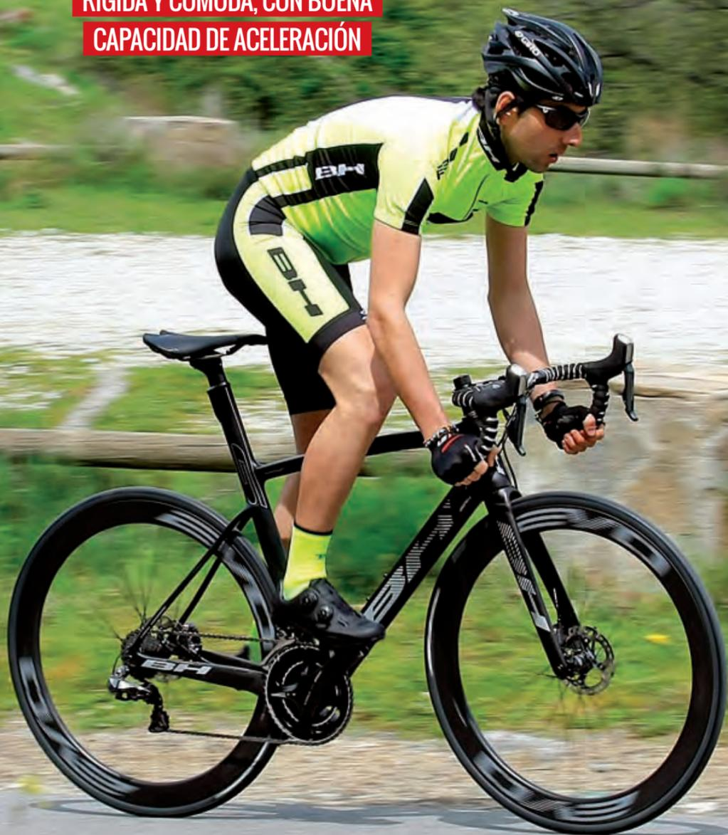
que proporciona un amplio espacio entre las vainas y concede al triángulo trasero altos niveles de rigidez y sensibilidad, además de permitir un amplio espectro de compatibilidades en la elección de bielas.
